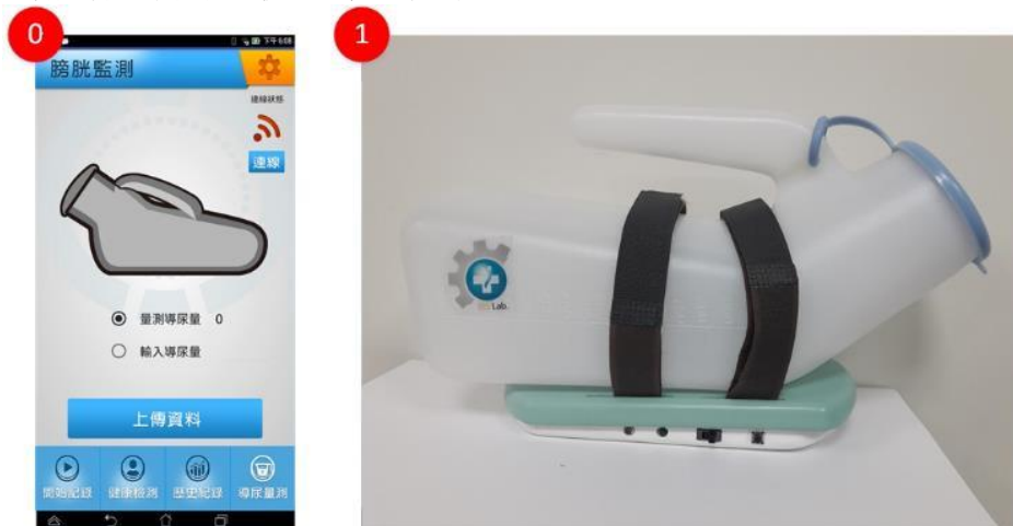
圖 39 導尿量測功能頁面與裝置示意圖
